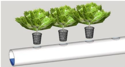
Figura (1.) Lechuga alojada en canastillas que descansan en la tubería.
