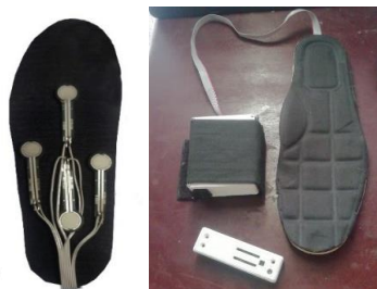
Fig. 5. Distribución de los sensores en el prototipo de plantilla inteligente propuesto
