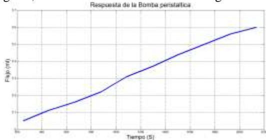
Fig. 18. Linealidad de las bombas peristálticas.
