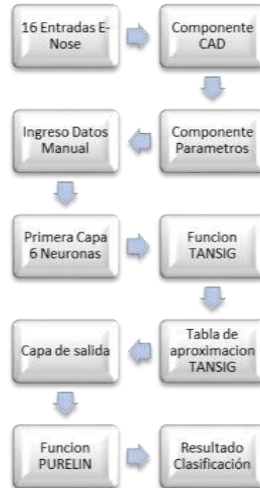
Fig.4. Proceso para implementar la RNA en el dispositivo lógico programable.
