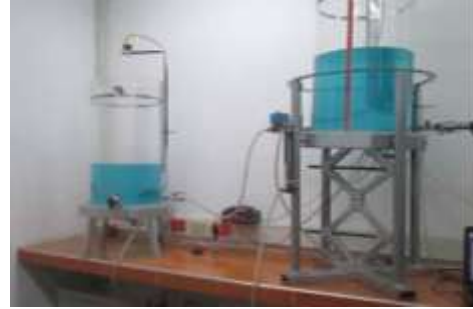
Fig. 1. Sistema de tanques interactivos
