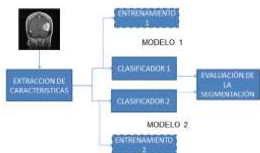
Fig. 1. Diagrama de bloques del proceso de segmentación de imágenes mediante clasificación de píxeles.
