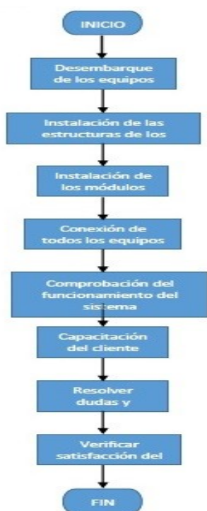
Figura 7. Proceso de instalación. (Fuente: elaboración propia, 2020).
