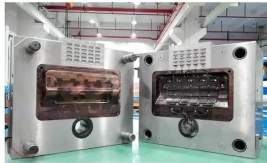
**Figura 3.** Modernos moldes para fundir a presión piezas de motor que luego serán mecanizadas.
