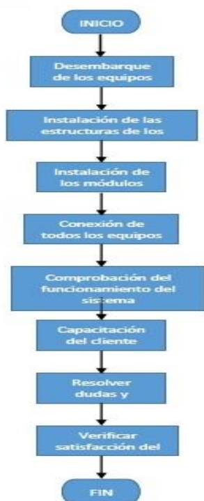
Figura 7. Proceso de instalación. (Fuente: elaboración propia, 2020).
