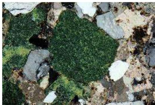
Figura 7. Muestra de Sección 3. Glauconita. Lámina fotográfica en nicols paralelos. Fuente: Autores.
