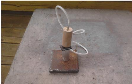
Figura 1. Prueba de Hess. Montaje y cebado. Fuente: Autor(es).
