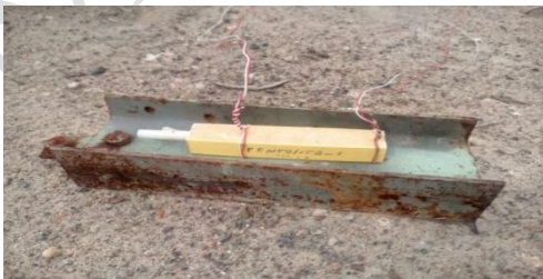
Figura 2. Medición de VoD carga lineal de Pentolita. Fuente: Autor(es).
