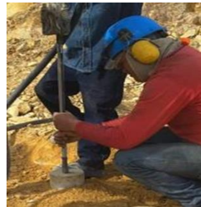
Figura 2. Perforación del cilindro (viga).
