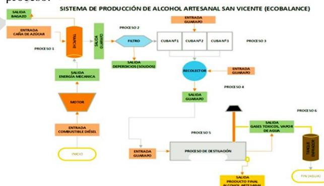
**Figura 2:** Eco-balance de los procesos de la destilería San Vicente.
