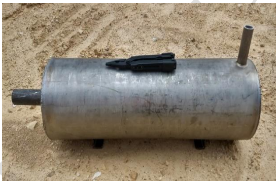
Figura 2. Modelo a escala 1:49 de la caldera de 700 Hp. Fuente: Autor(es)
