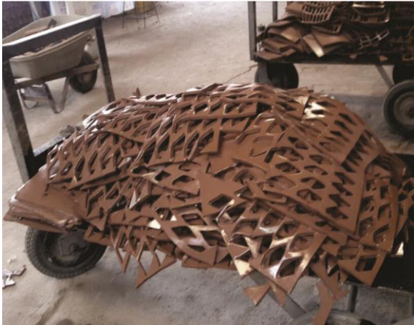
Figura. 5. Residuo material después de troquelado.
