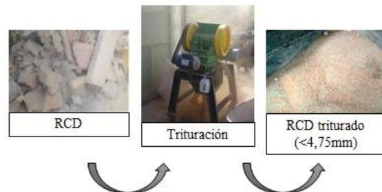
Figura 1. Adecuación de RCD en ARF.
