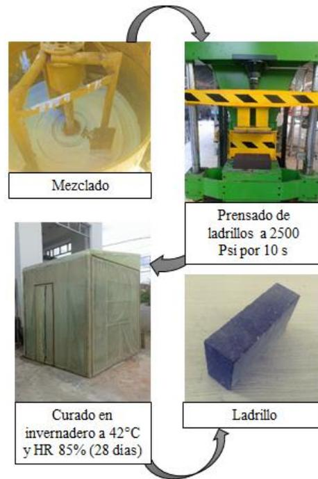
Figura 3. Proceso de elaboración de ladrillos.
