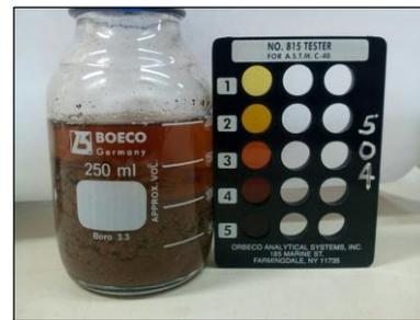
Figura 6. Ensayo de impurezas orgánicas de AFR (NTC 127).
