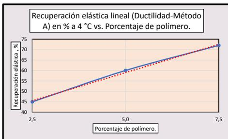
**Figura 2.** Recuperación elástica lineal (Ductilidad-Método A) en porcentaje a 4°C vs. Porcentaje de polímero.
