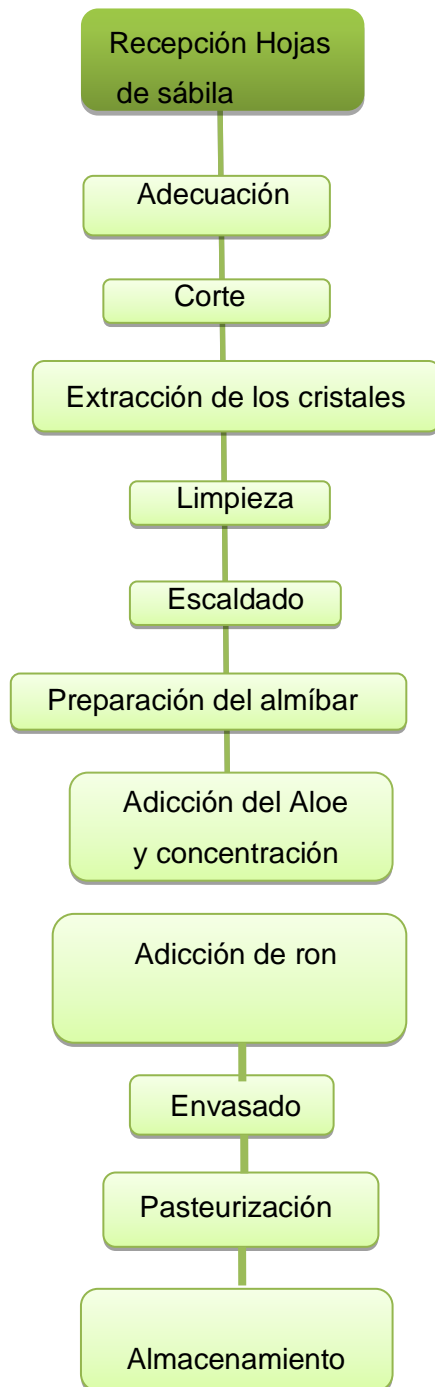
Figura 1. Diagrama de flujo de la elaboración del licor concentrado de Aloe Vera (Aloe Barbadensis Miller) .
