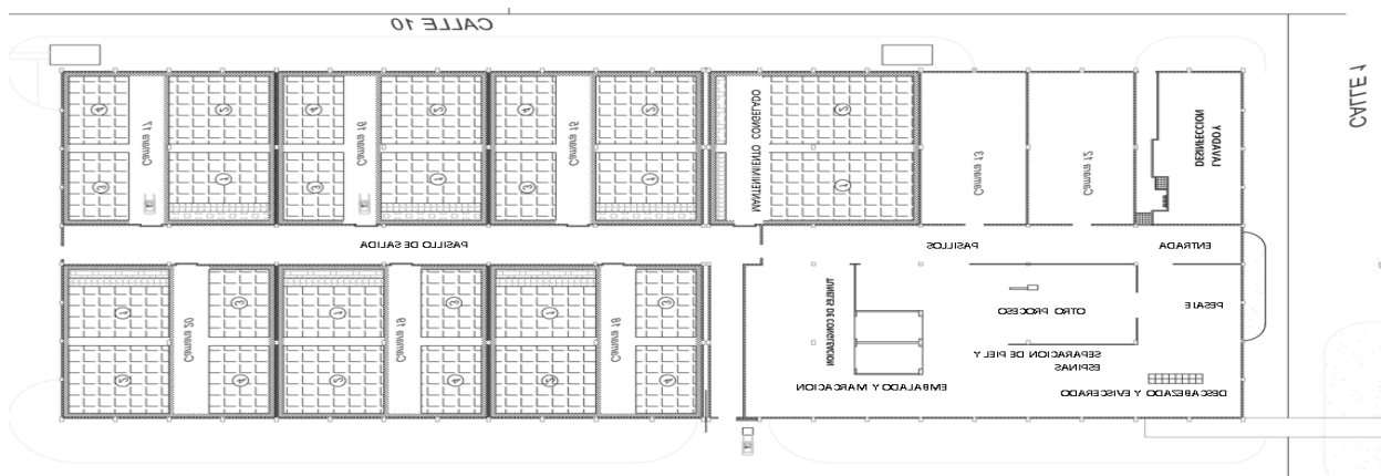
Figura 5. Diagrama de planta del proceso de picadillo de pescado congelado
