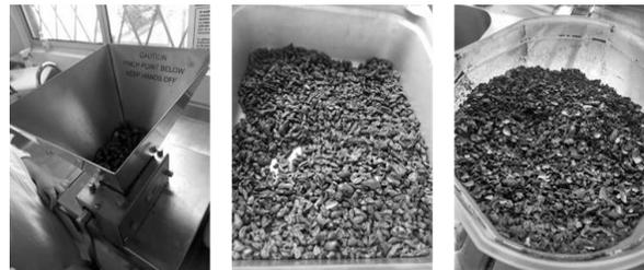
Figura 4. Triturado y descascarillado
