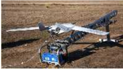
Imagen 1. Dron de ala fija. Fuente: (Addati y Pérez, 2014, p.6)
