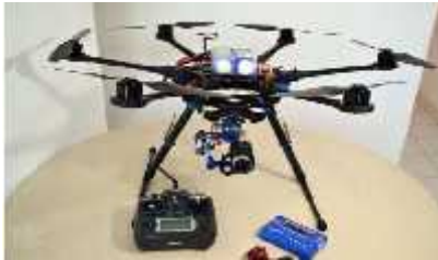
Imagen 2. Dron de ala rotatoria. Fuente: (Addati y Pérez, 2014, p.6)
