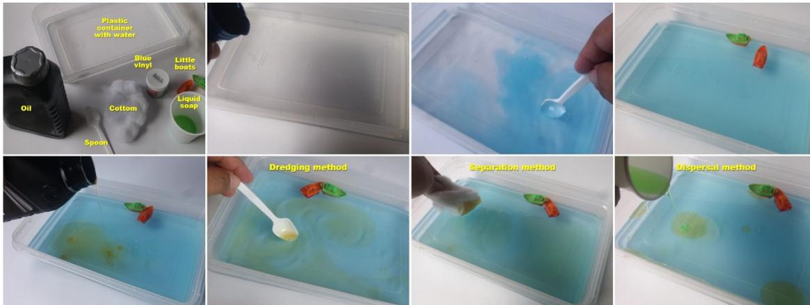
**Figura 7.** Pasos para realizar una simulación de derrame de hidrocarburo en un medio hídrico.
