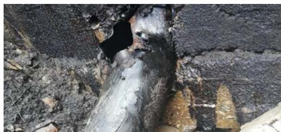
**Figura 9. tramo del OCLC afectado por acciones subversivas.** Fuente: ECOPETROL.
