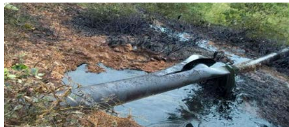
Figura 11. tramo del OCLC violentado en la vereda las Bancas. Fuente: Archivos del periódico el Espectador.
