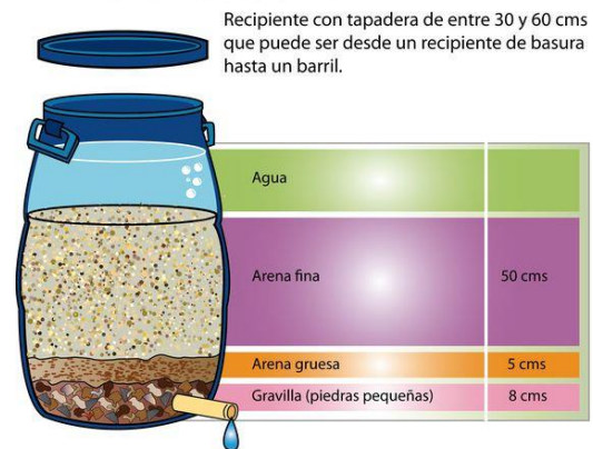
Figura 4. Filtro casero para aguas jabonosas. Fuente: (Kral, 2011).
