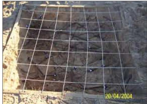
Figura 6. Seguimiento de la raíz identificada en los radargramas
