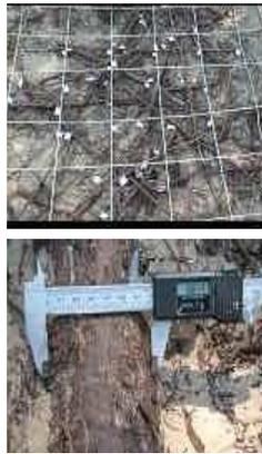
Figura 5. Excavación de las raíces mediante sopladora, etiquetado y medición de diámetro de las raíces
