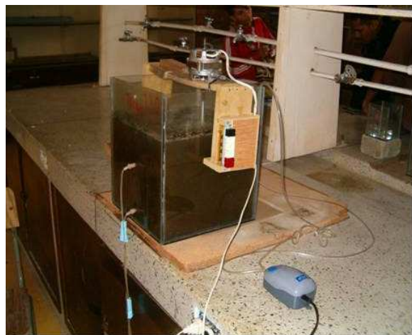
Figura 4. Representación Esquemática del Reactor Tipo (SBR)
