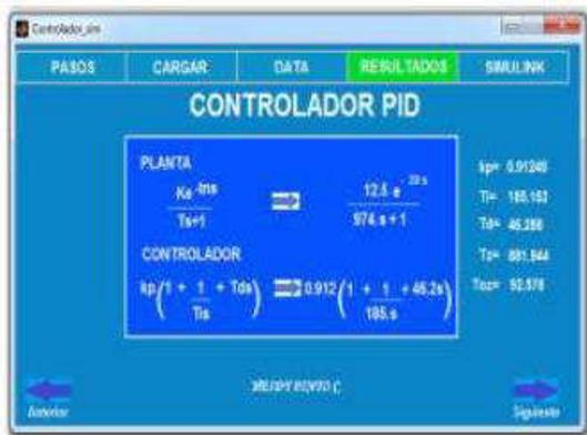
**Figura 5.** Resultados de la planta del proceso y Controlador PID.
