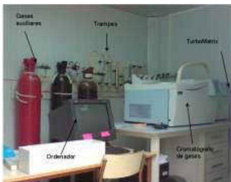
Figura 2. Equipos de medida de COV
