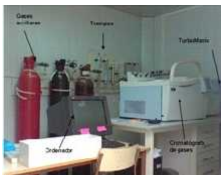
Figura 2. Equipos de medida de COV
