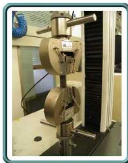
Figura 2 Ensayo de tracción ISTRON 3367
