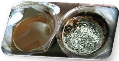
Figura 10. Comparación de una emulsión inversa y una dispersión de aceite crudo.
