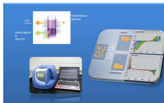
Figura 6. Principio de Funcionamiento del Turbiscan.
